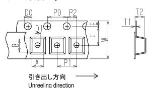
・シールテープ 剥離強度 The force to peel away the fixing seal tape 0.1~1.0N
